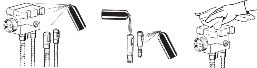
Рис. 13. Очистка держателя наконечников, шлангов и терминалов
